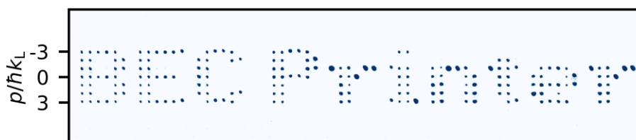
Figure 1 : Illustration d'une imprimante à atomes. Chaque colonne de l'image correspond à une image expérimentale d'absorption, obtenue après préparation d'une superposition arbitraire d'états d'impulsion p = \{-3, -2, -1, 0, 1, 2, 3\}\hbar k_L (avec k_L = \frac{2\pi}{d} et d le pas du réseau) et temps de vol.
